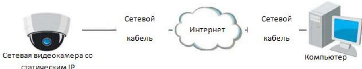
Рисунок 3.4.1: Доступ к сетевой камере со статическим IP напрямую
