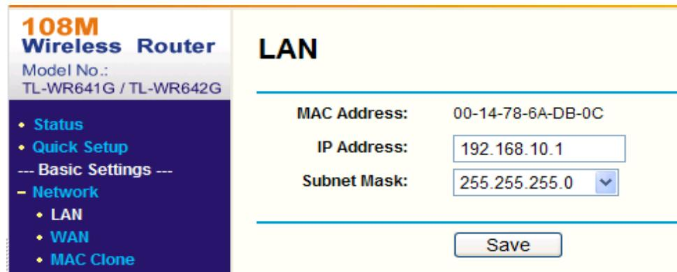
**Шаг 3:** Создайте конфигурацию портов в настройках виртуального сервера Передающего устройства. Например, порты для одной купольной видеокамеры настраиваются на значения 80 и 8000, а ее IP адрес 192.168.1.23. Порты для другой купольной видеокамеры настраиваются на значения 81 и 8001, а IP 192.168.1.24. Затем, активируйте все или только TCP протоколы. Активируйте конфигурацию портов нажатием кнопки Save.
